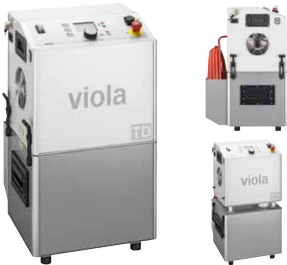
Das portable und leistungsstarke Hochspannungsprüf- und Diagnosegerät viola ist in zwei unterschiedlichen Ausstattungsvarianten lieferbar. In der Standardvariante dient es der Kabel- und Kabelmantelprüfung von Mittelspannungskabeln bis 35 kV und von elektrischen Betriebsmitteln. Eine weitere Funktion ist die Isolationsprüfung an elektrischen Betriebsmitteln. Die patentierte VLF-truesinus®-Technologie (Sinusspannung mit 0,1 Hz) garantiert eine hohe Messgenauigkeit.
